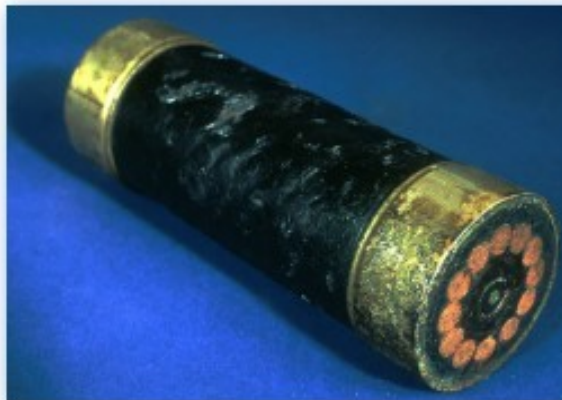
Fig. 1: Secțiune transversală a cablului utilizat în 1866 ( http://www.electrledge.com/greymatter/images4/cable_atlantic.jpg )
